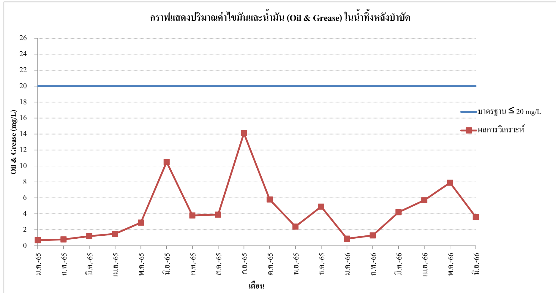
ภาพที่ 4.5 กราฟแสดงปริมาณค่าไขมันและน้ำมัน (Oil & Grease) ในน้ำทิ้งหลังบำบัด
